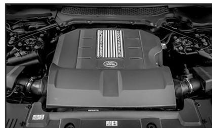
Линейка силовых агрегатов, предлагаемых для Range Rover Sport 2013 модельного года, весьма обширна. Для топовых версий предлагается 5-литровый бензиновый V8, выдающий 510 л. с. мощности и 625 Н·м крутящего момента. Со временем появилась модификация SVR, в которой этот двигатель форсирован до 550 л.с.
